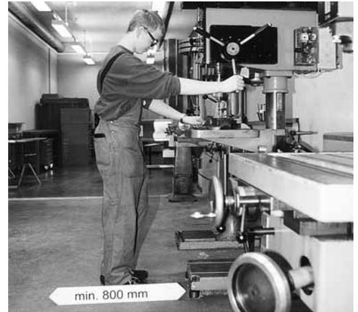
Un passage de 800 mm doit être prévu pour permettre un travail sûr.
