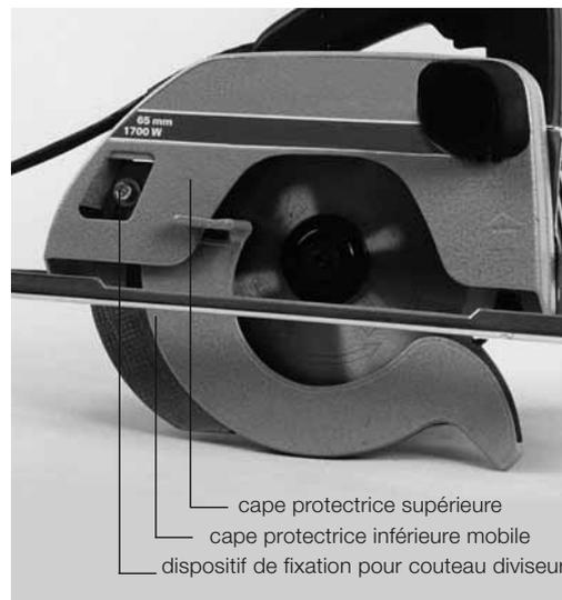
Figure 1: scie circulaire à main protégée correctement.
