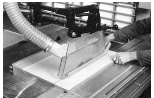
Figure 9: cape de protection équipée d'un manchon d'aspiration.
