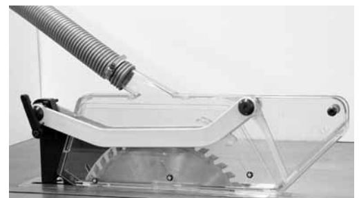
Figure 3: couteau diviseur équipé d'une cape de protection.
