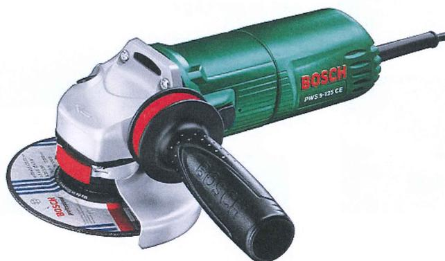
La meuleuse d'angle (aussi tronçonneuse à disque ou FLEX) est généralement une machine manuelle à entraînement électrique dotée d'une meule ronde à rotation rapide. La meuleuse d'angle est entraînée par un engrenage angulaire qui donne son nom à cette dernière. (Source: Wikipedia)
