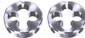
Il existe des filières ouvertes et fermées. Le diamètre des filières ouvertes est réglable, ce qui permet d'usiner des filetages d'un diamètre légèrement réduit en prévision d'un traitement de surface par exemple. Les filières sont toujours livrées fermées par leur fabricant et, au besoin, elles peuvent être ouvertes à l'atelier ou au magasin d'outillage.
