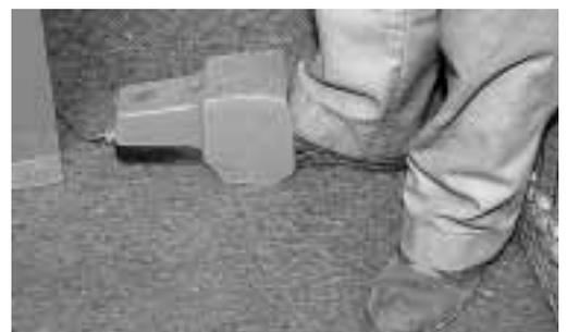
Figure 5: pédale de commande avec capot de protection.
