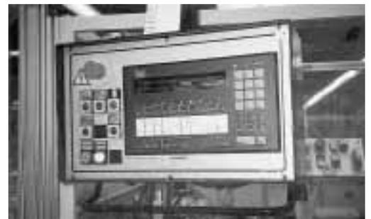
Figure 6: tableau de commande tactile d'une ligne de production.
