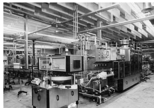
Baffles en panneaux acoustiques de laine minérale dans une entreprise produisant des boissons (installation de remplissage).
